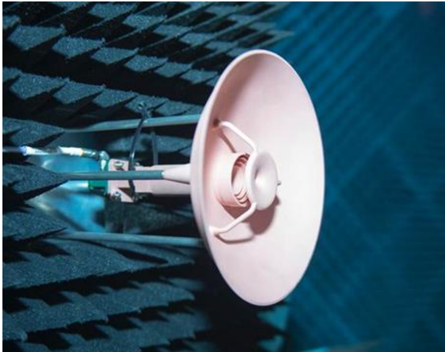
Antenne micro-onde produite par impression 3D Photo : ESA / SWISSto12 - Image courtesy European Space Agency
