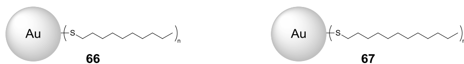
Figure 61. Nanoparticules d'or portant des ligands décanethiol (à gauche) ou dodécaneethiols (à droite).
