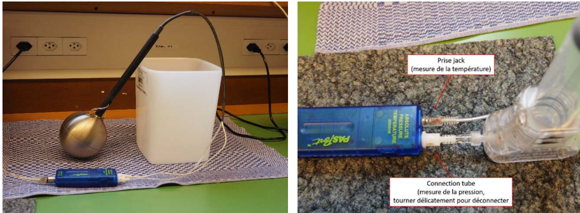
Figure 1: Schéma de principe de l'expérience pour la vérification de la loi de Boyle-Mariotte
