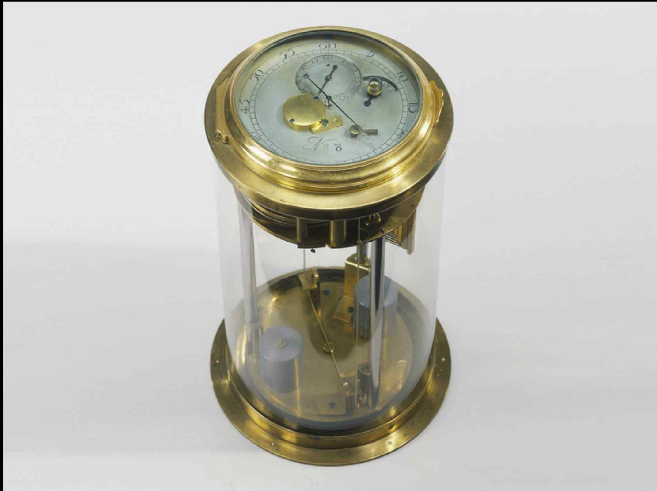
Ferdinand Berthoud, Horloge marine n. 8, 1767, acier, laiton, plomb, verre, Musée des arts et métiers, Paris.
