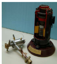
Ill. 1 Comparaison des dimensions: le turbocompresseur développé par Jürg Schiffmann (à g.) et un compresseur traditionnel.
